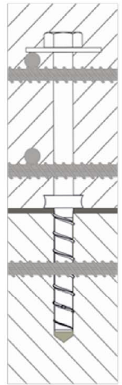
Verankerung mit einbetoniertem Verbinder
