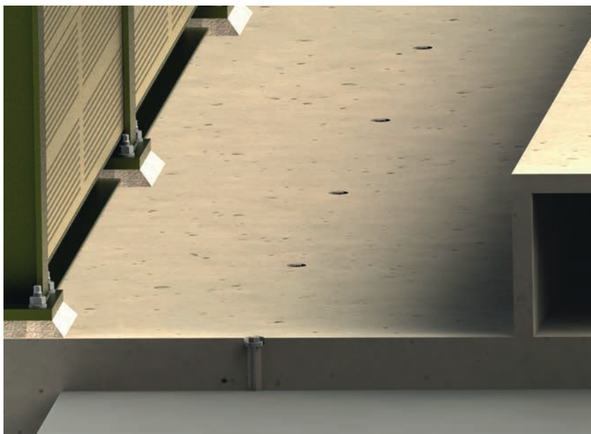
Nachträgliche Befestigung von Brückenkappen bei Straßenbrücken mit der TOGE TSM BS VS
