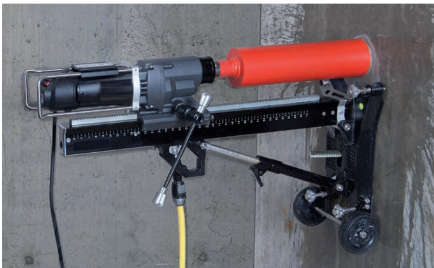
Befestigung von Kernbohrgeräten in Beton
