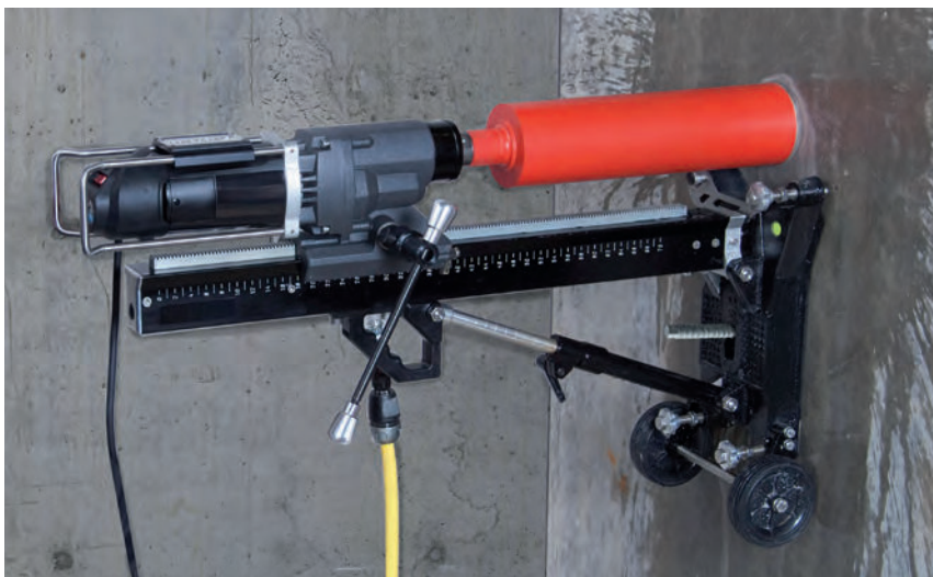
Befestigung von Kernbohrgeräten in Beton
